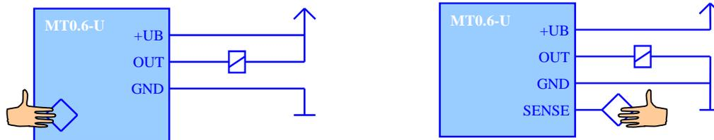
Bild 1: Schematische Darstellung einer Relaissteuerung mit dem MT0.6-U in zwei beispielhaften Varianten:
