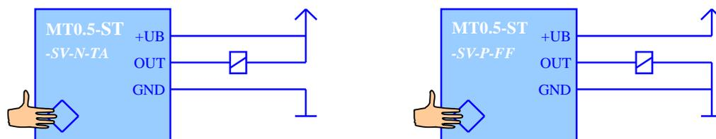
Bild 1: Schematische Darstellung einer Relaissteuerung mit dem **MT0.5-ST** in zwei beispielhaften Varianten:
