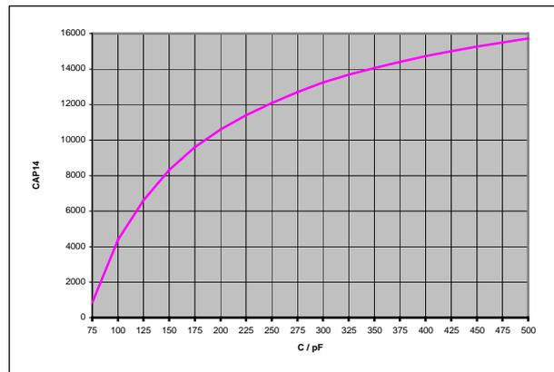
Bild 3:  $CAP / 14\text{Bit} = f ( C / pF )$
