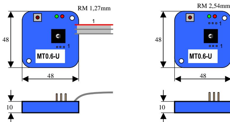
Bild 4: Abmessungen
