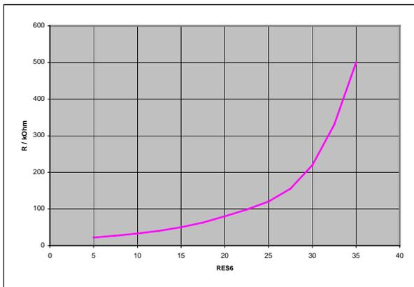
Bild 2:  $R / k\Omega = f ( RES / 6\text{Bit} )$
